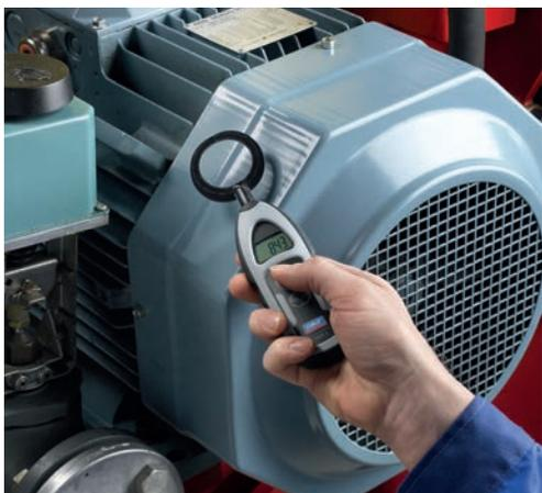
Наиболее подвержены электрической эрозии подшипники в электродвигателях, управляемых с помощью частотных преобразователей. При использовании в рамках программы техобслуживания по фактическому состоянию детектор EDD Pen может помочь определить подшипники, которые с большей вероятностью выйдут из строя, и предотвратить внеплановые простои оборудования.
