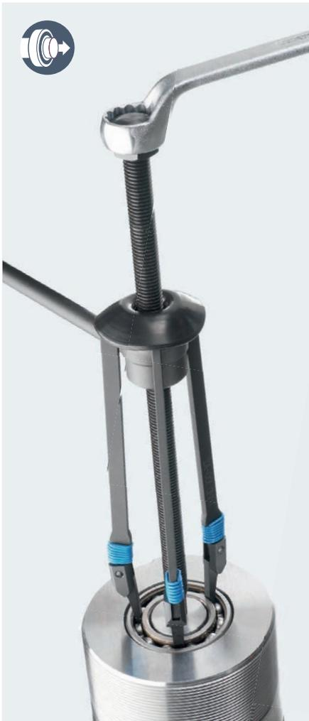
Захваты лап оптимизированы для точного и надёжного размещения в дорожке качения наружного кольца подшипников SKF без необходимости удаления сепаратора.
