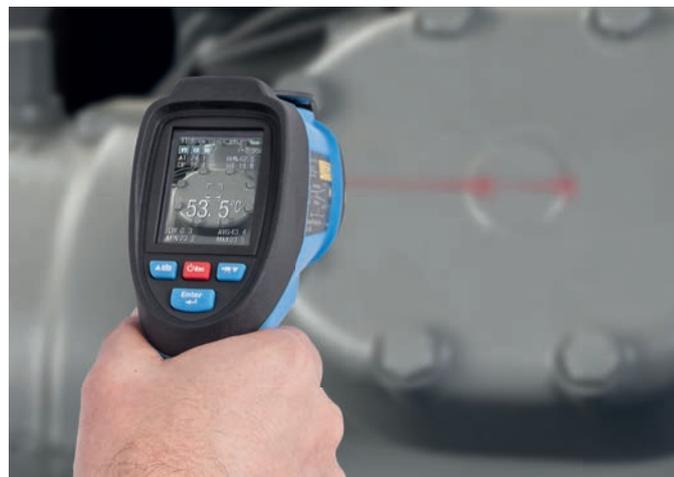
При использовании бесконтактного режима измерений термометр воспринимает тепловую энергию, излучаемую объектом, с помощью инфракрасного детектора. При наведении на объект инфракрасный датчик собирает энергию, производя сигнал, который микропроцессор преобразует в результат измерения, отображаемый на дисплее с подсветкой. При нажатии кнопки инфракрасный датчик измеряет температуру объекта непрерывно. Это обеспечивает быстрое и точное измерение в реальном времени.
