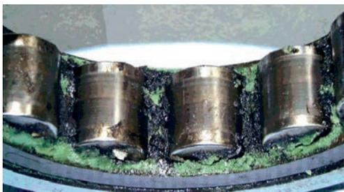
Деградация смазки, вызванная прохождением электрического тока
