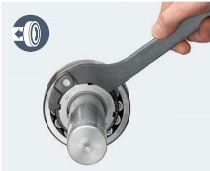
Четыре ключа позволяют затягивать гайки 24 размеров
