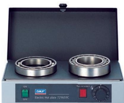
Температура нагрева подшипника регулируется термостатом
