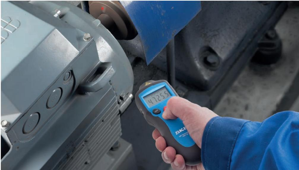
Оптическая лазерная система обеспечивает простое и быстрое измерение на безопасном расстоянии от узлов вращения.
